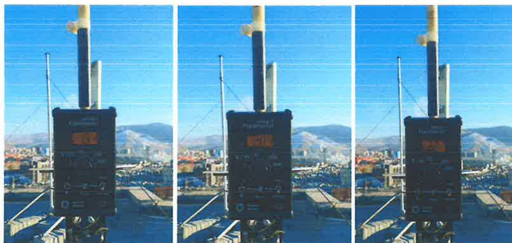
Зураг 9. Сонгинохайрхан дүүрэг, 13 дугаар хороо, 2 дугаар байрны дээвэрт бааз станцын нэвтрүүлэх антены дэргэд хийсэн хэмжилт
