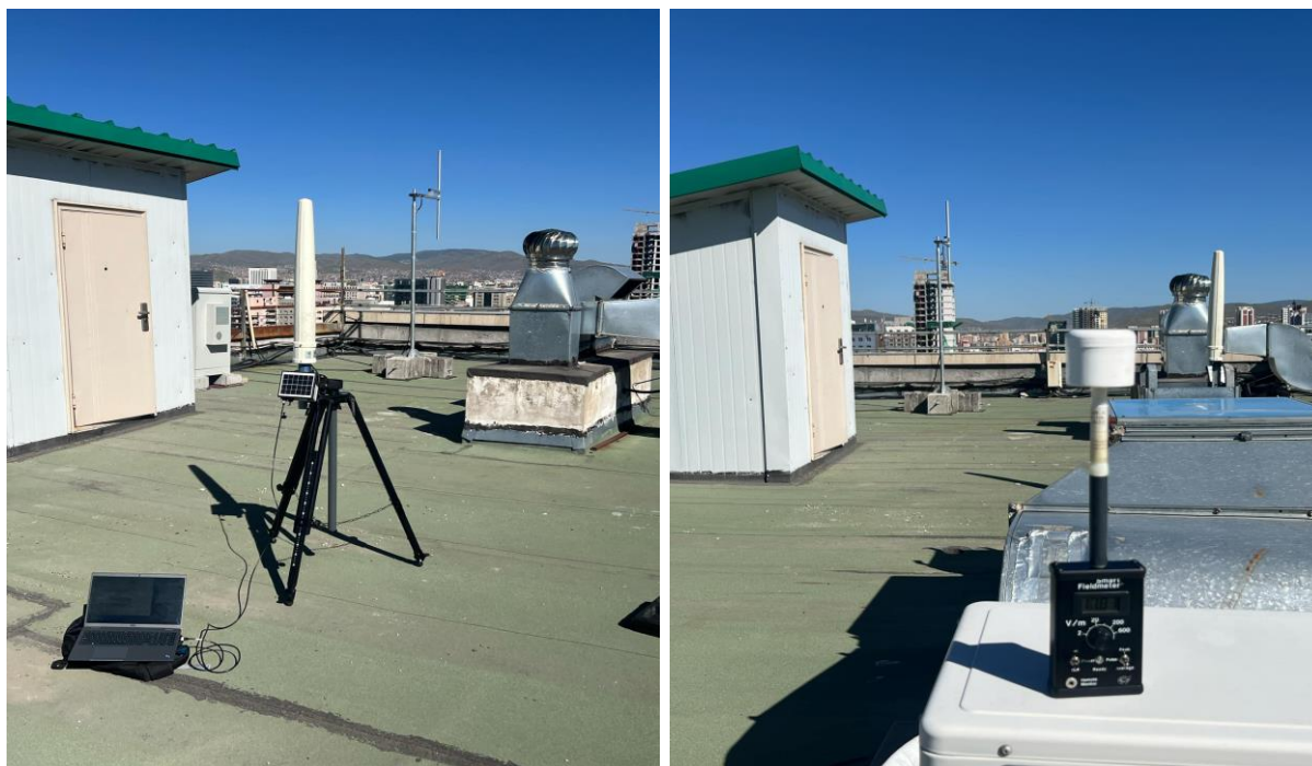
Зураг 2. Радио станцын нэвтрүүлэгчийн антены дэргэдэх хэмжилт.
